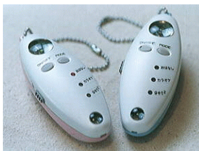
FIG. 4.1: LoveGety - Son utilisation est simple, il faut choisir parmi les trois modes à disposition (conversation, karaoké et Get2 pour les plus décidés) et l'utilisateur est alerté lorsqu'il croise une personne qui correspond à son choix et qui a donc choisi le même mode.
